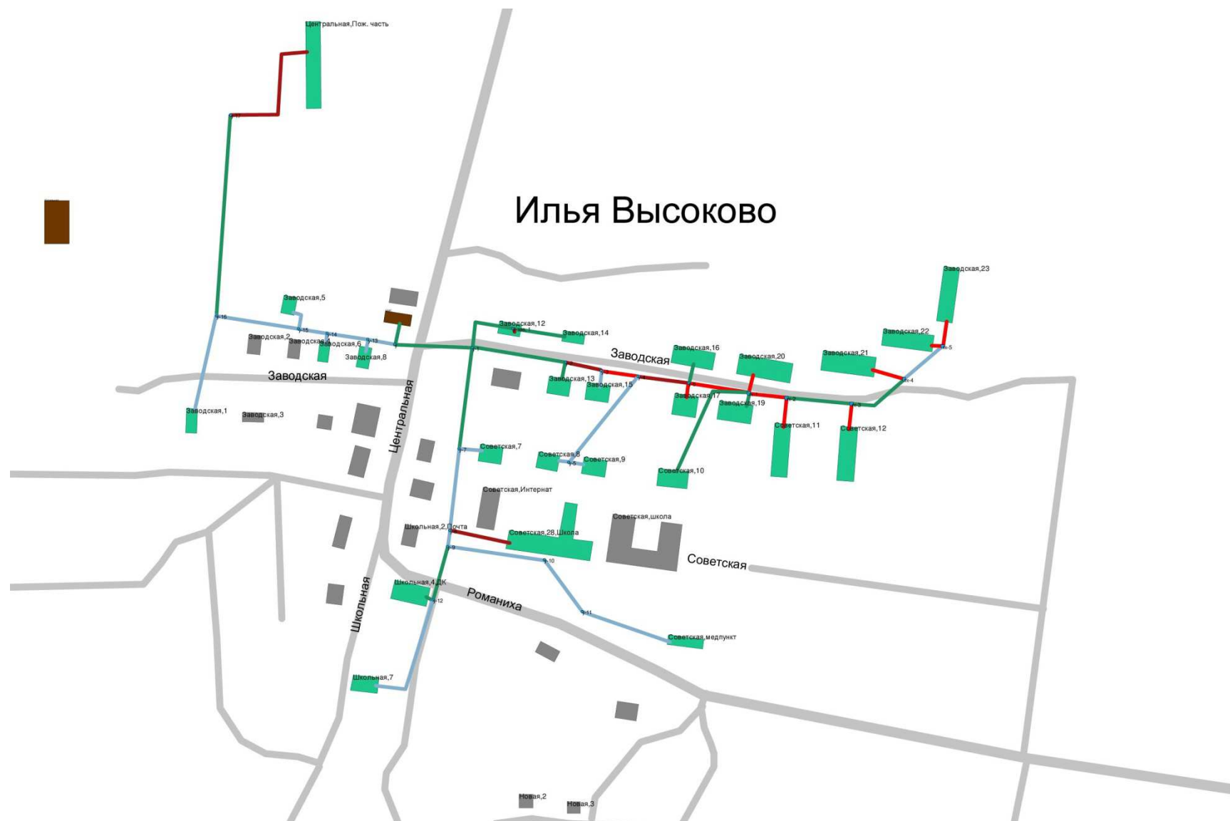
Рис. 6. Наладка системы теплоснабжения – котельная с. Илья-Высоково
