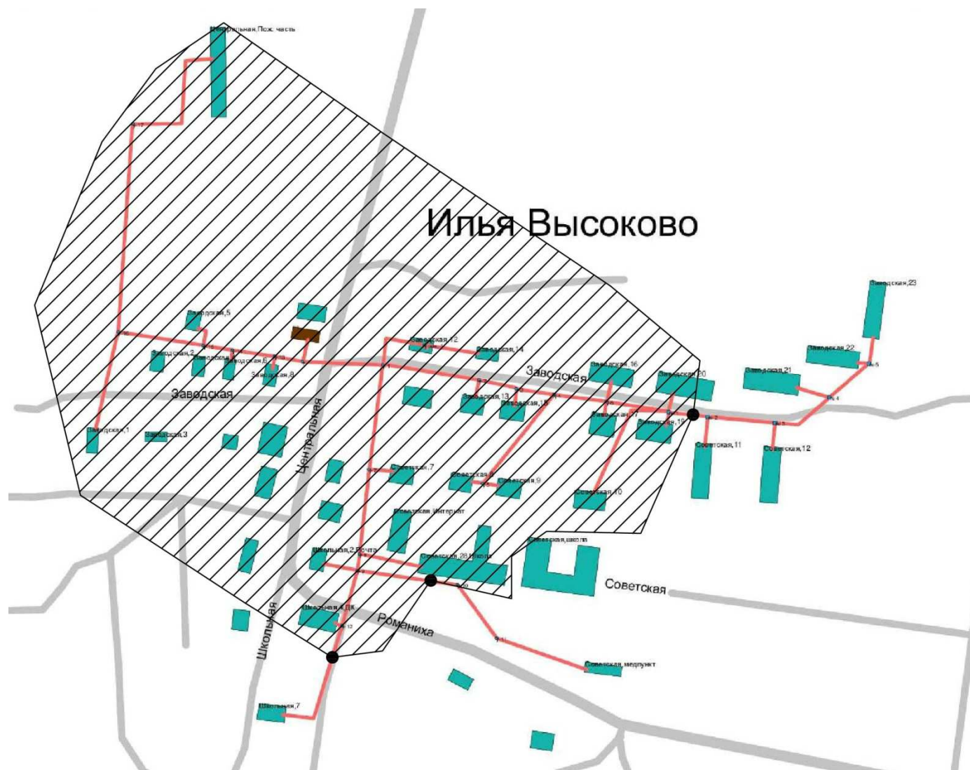
Рис. 6.1 Эффективная зона теплоснабжения от котельной с. Илья-Высоково
